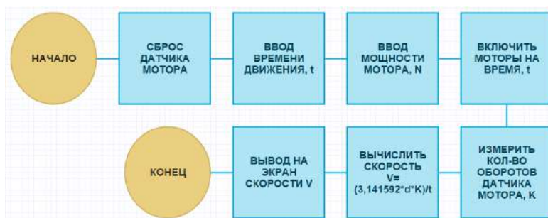
Рис. 1. Алгоритм расчета скорости роботележки
